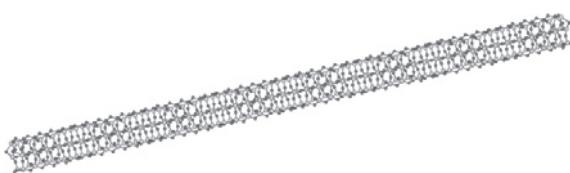
図 2.3 プログラムの分析に用いられたシリカナノチューブの構造
