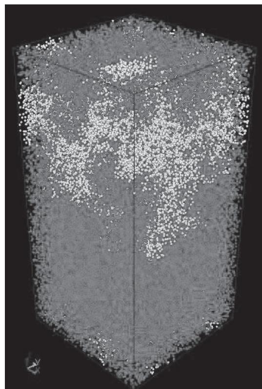
図 8 10 万粒子の沈降シミュレーションのスナップショット。KAPSEL ホームページ[3]に動画がある。
