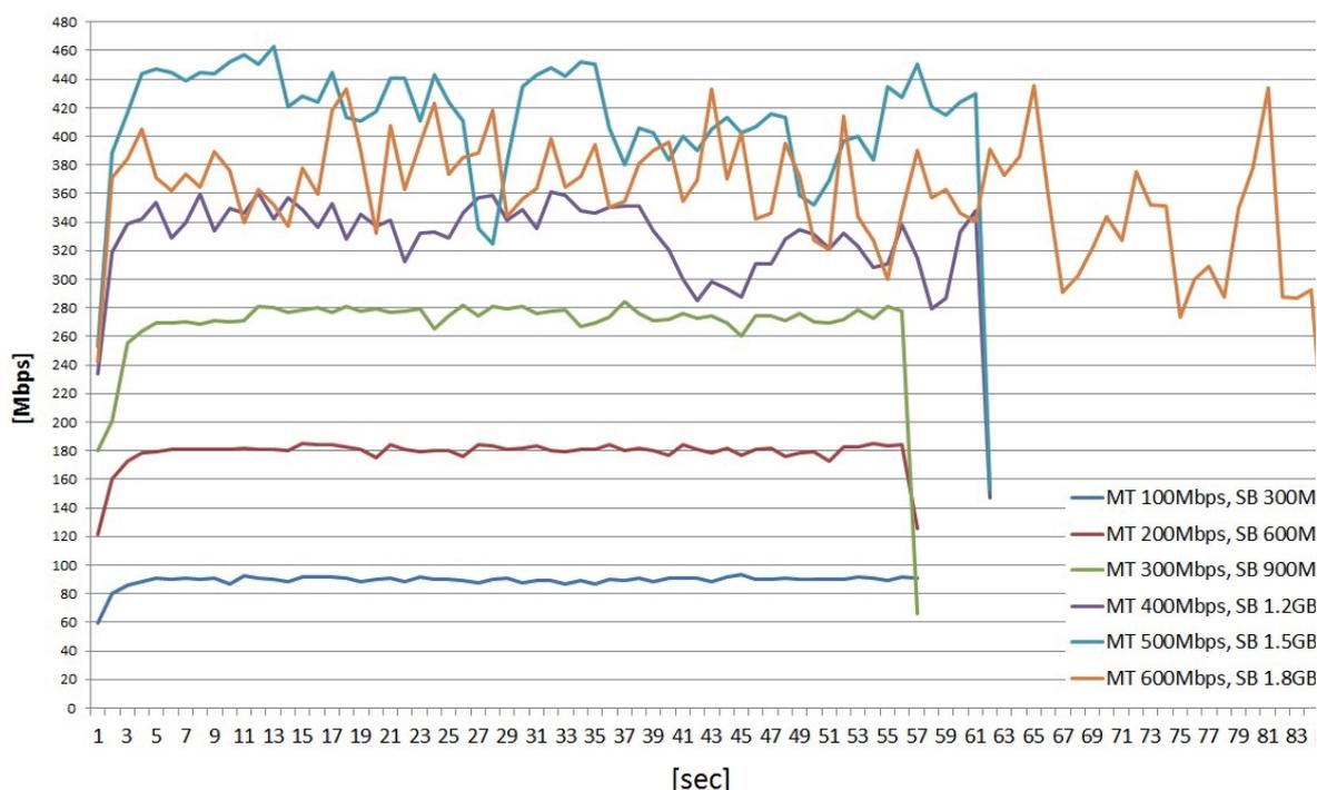
図5 HpFPによる京都大学学術情報メディアセンターと情報通信研究機構サイエンスクラウドシステムの間で基礎的な通信実験結果：同じ環境でiperf (TCP) では340Mbps程度であった。
